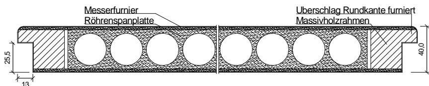
Türstärke ca. 40mm, Rahmen Massivholz mit Band- und Schlossverstärkung, unten als 2. Riegel zusätzlich Vollspanstreifen, Mittellage Röhrenspanplatte, Aufbau 5-fach, *querfurniert*, Längskante *furniert*, Überschlag 2- bzw. 3-seitig *Rundkante furniert* (**Eiche** hat oben immer einen eckigen Überschlag, **am. Nussbaum** und **Eiche astig** nur mit 3-seitig eckigem Überschlag)
